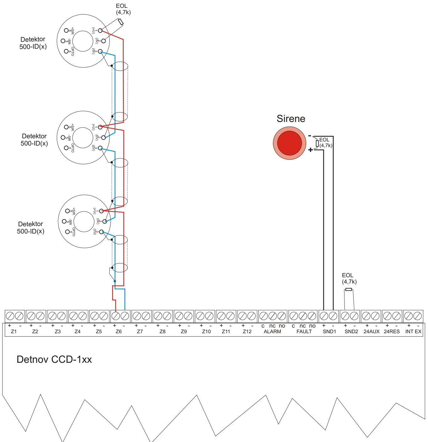
Kobling av detektor 500-IDx mot sentral CCD-1xx. Intern sirene i 500-IDx som systemsirene.
